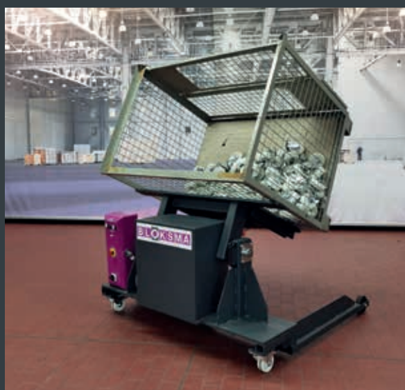
G7 Elektrohydrauliczny podnośnik do ciężkich ładunków do 1000 kg. Zwiększenie maksymalnego udźwigu - na życzenie (wymaga indywidualnej analizy)
