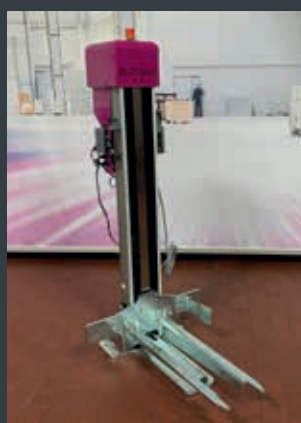
G8 Mały i elastyczny, do 200 kg, z elektrycznym napędem liniowym, musi być przytwierdzony do podłoża.
